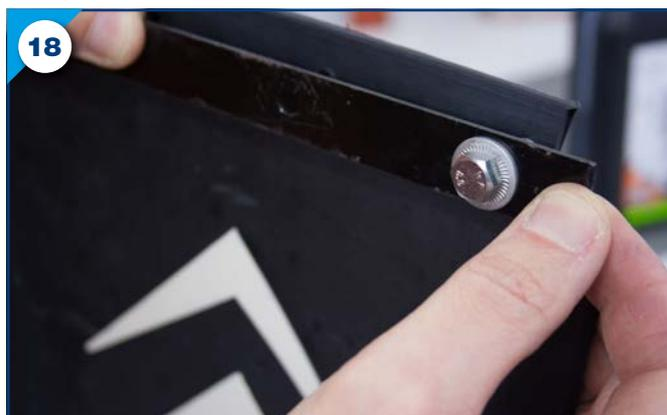
**4.** Préparez l'ensemble de visserie issue du kit réf. 0300802 (photo 15), posez une rondelle sur chacune des vis (photo 16). Présentez la bavette sur le support et posez la visserie dans les trous percés précédemment
