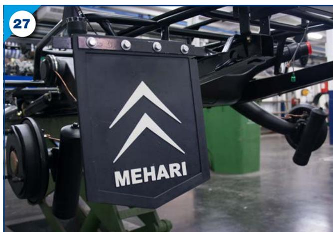
6. Présentez le support équipé de la bavette sur la plateforme (photo 24), et fixez-le avec une vis, une rondelle et un écrou issu du kit de visserie 0300802 (photos 25 et 26).
