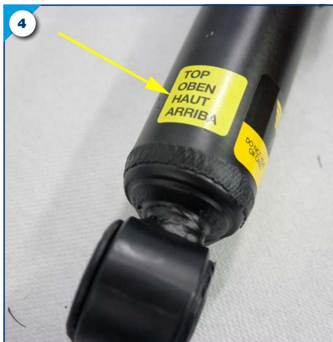
**2.** Un amortisseur hydraulique nécessite d'être amorcé manuellement avant le montage. Pour ce faire, détendez et comprimez l'amortisseur comme décrit par les illustrations 5 et 6. Cet « aller-retour » doit être répété 5 fois pour un amorçage efficace.
