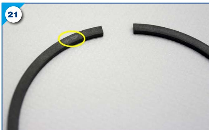
**8.** Placez une pince à segment au niveau de la coupe du segment d'étanchéité en s'assurant que la mention « Top » soit bien positionnée vers le haut (photo 22), et positionnez le segment sur la gorge intermédiaire du piston (photos 23 et 24).
