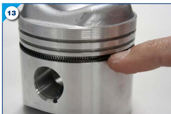
**4.** Placez une pince à segment au niveau de la coupe du segment racleur et écartez ce dernier (photos 14 et 15), puis positionnez le segment sur le piston (photos 16 et 17).
