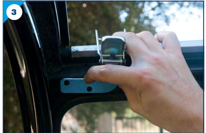
2. Repérez les trous de fixation (photo 2) et présentez le verrou gauche (photo 3). Positionnez le pare-soleil correspondant et fixez l'ensemble à l'aide de deux vis M5 issues du kit réf.2801150. Aidez-vous d'un cliquet équipé d'une douille de 8mm (photos 4 à 5). Le premier pare-soleil est posé (photo 6), répétez l'opération sur le côté opposé (photo 7).
