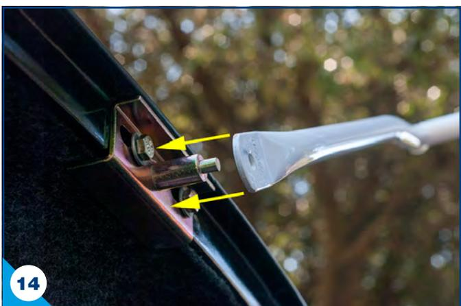
2. L'ensemble support avant de capote est monté et mobile.
