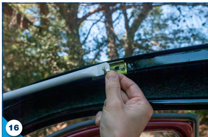
Notez que les trous de fixation oblongs de ces supports latéraux permettent le réglage de la tension de la capote une fois cette dernière en place. Il sera éventuellement nécessaire de régler dans un second temps le positionnement du support latéral pour obtenir une tension optimale de la capote. Les supports latéraux seront bloqués à l'aide d'un serrage maximal de leurs vis de fixation à cette occasion.
