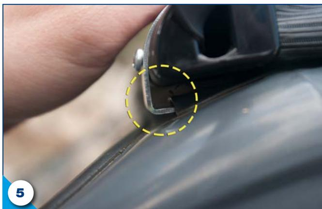
2. Tirez sur une des deux boucles de la sangle élastique (photo 3 - repère n° 1), situées de chaque côté de la capote au niveau du pare-brise (une à gauche, une à droite) pour retirer l'ergot de maintien en métal (photo 3 - repère n° 2) de son logement sur le haut de la baie de pare-brise (photo 3 - repère n° 3), selon la séquence illustrée par les photos 3 à 5. Désengagez-le complètement en le relevant (photos 6 et 7). Répétez l'opération sur le côté opposé.
